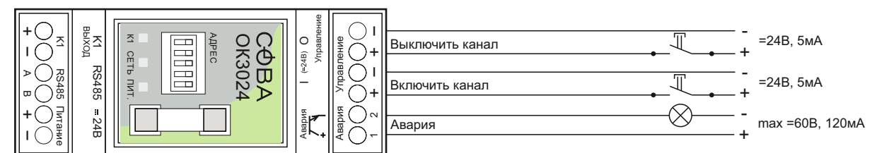
Рисунок 4. Схема организации дискретного управления
